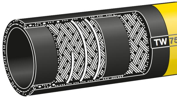
Tankwagenschlauch Gelbring: Tankwagenschlauch 'Gelbring' mit abknickfester Stahlwendel, innen und außen glatt. Für Mineralölprodukte aller Art mit Aromatenteil bis 50%. Temperaturbereich -30° bis +90°C. Elektrischer Widerstand < 10° Ohm. Bauartzugelassen nach Norm VG 95955 Typ S. Entspricht EN 12115 und EN 1761. Type STW = verstärkte TW-Ausführung. Besonders geeignet als Marine-Bunkerschlauch (Einzelheiten siehe Seite 129).
